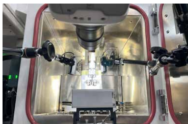
Test setup with STEP Lab drop weight tower and Photron high speed camera. / Configurazione di prova con torre di caduta STEP Lab e telecamera ad alta velocità Photron.
